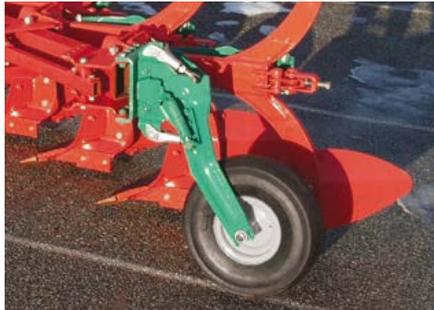
**Roue de contrôle de profondeur arrière**
