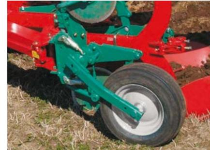
**Roue de contrôle de profondeur arrière**
