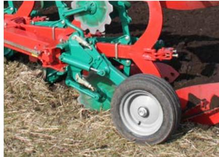
**Roues de contrôle de profondeur arrière avec bras télescopique**
