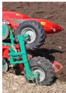
**Roues de contrôle de profondeur et de transport double**
