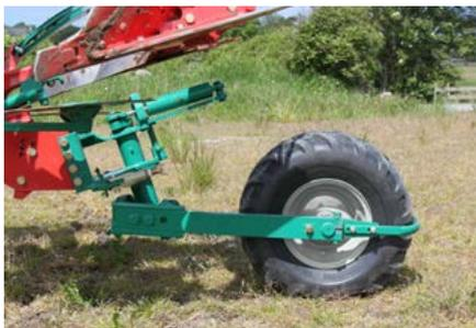
**Roues de contrôle de profondeur et de transport arrière**
