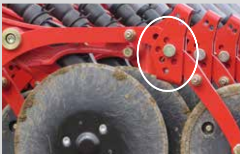
Roue plombeuse multi-positions pour un rappui efficace et un suivi de terrain parfait
