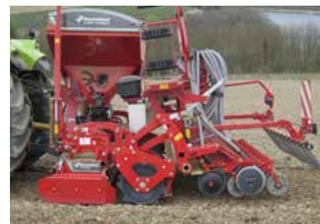
Profondeur de semis réglable hydrauliquement, ou mécaniquement.
