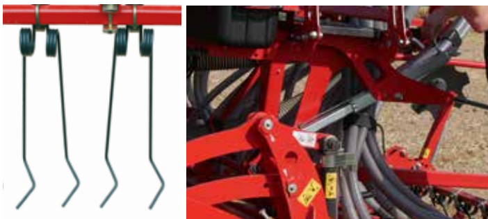
Réglage de la hauteur de la herse de recouvrement à dents en S à l'aide d'une manivelle.
