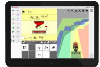
Kverneland Tellus 1200 le terminal ISOBUS avec jusqu'à 4 affichages simultanés et personnalisables
