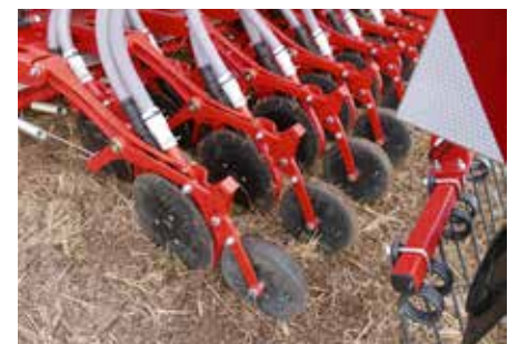
CX-II double entrée pour appliquer deux produits lors du semis
