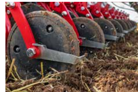
Décrottoirs de roue plombeuse, recommandé en terrain gras et collant.
