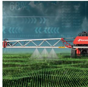
La technologie SpotSpray de Kverneland se base sur la pulvérisation localisée à partir d'une carte de détection.
