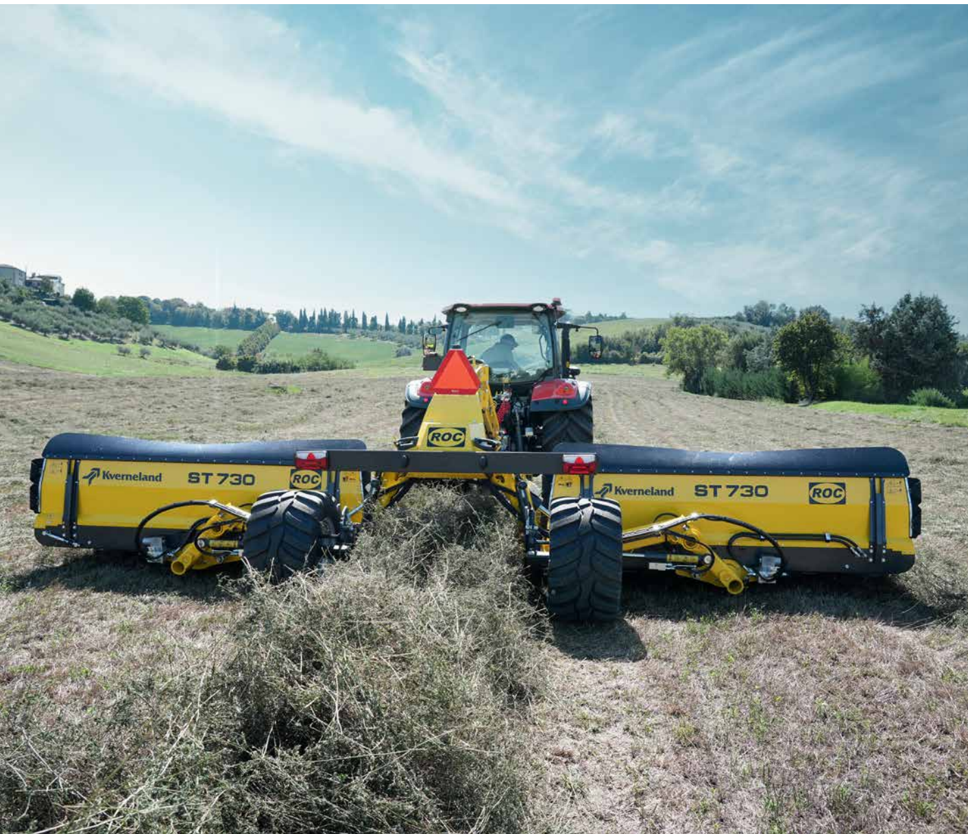
Le Kverneland ROC ST 730 peut être replié à une largeur de seulement 2,5 mètres pour le transport
