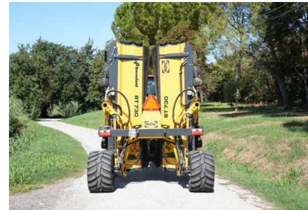
Le Kverneland ROC ST 730 peut être replié à une largeur de seulement 2,5 mètres pour le transport
