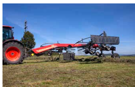
Dégagement par rapport au sol de 500 mm.
