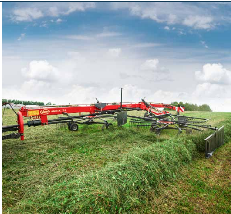
La conception andainage latéral permet de ramasser jusqu'à 15 m d'herbe.
