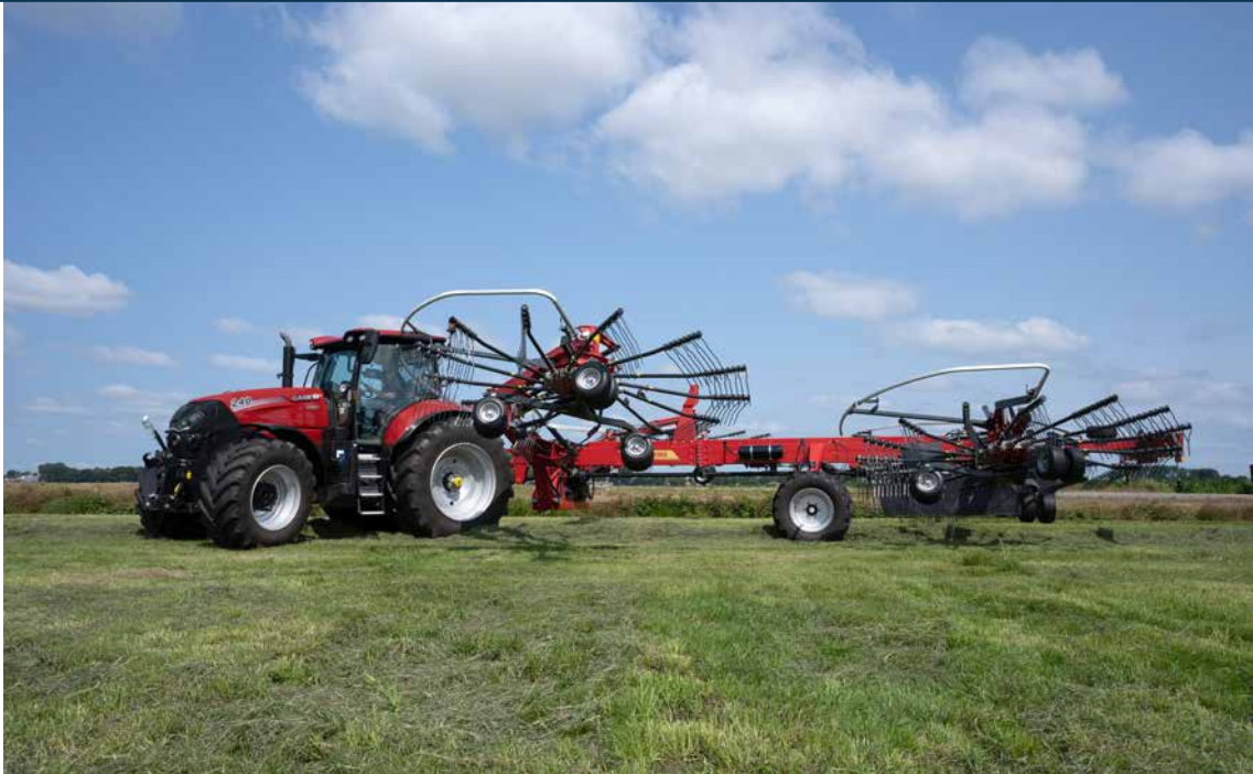
Les 4 rotors peuvent être soulevés individuellement.
