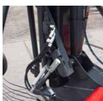
Verrouillage hydraulique au transport (option).
