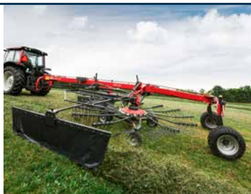
Une planche à andain repliable hydrauliquement équipe en standard l'Andex 774.
