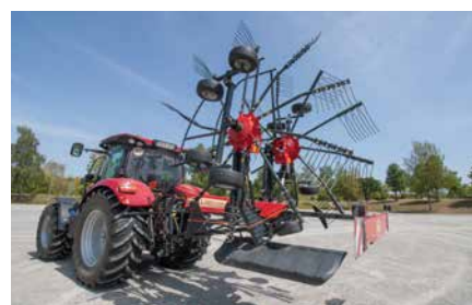
Position de transport compacte et sans quitter la cabine.
