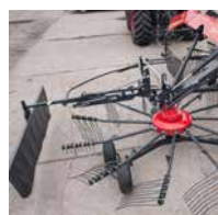
Repliage automatique de la planche à andain et béquille de stationnement.
