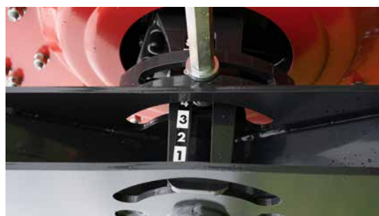
Vicon Index 1304 Réglage de la levée de came.
