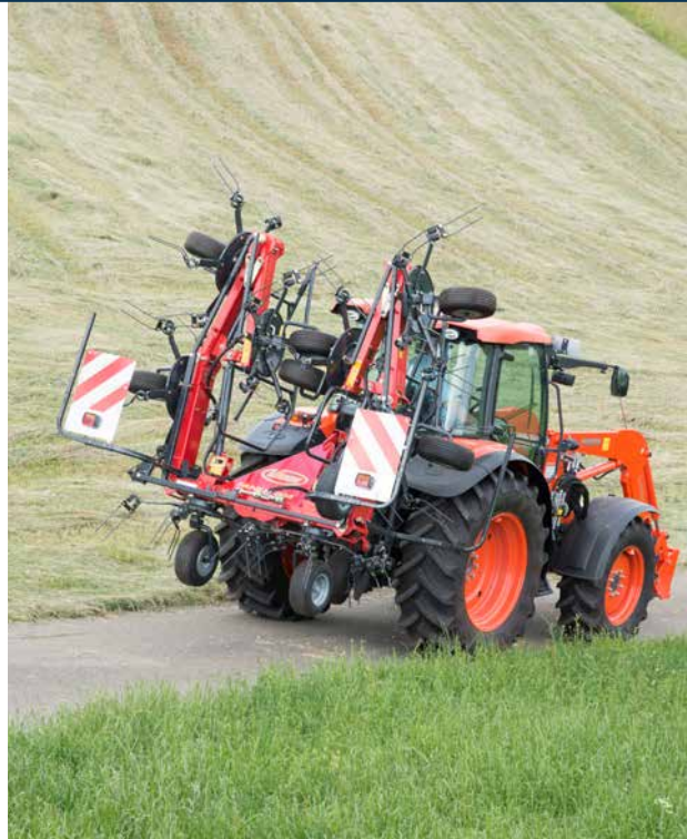
Fanex 804 se replie dans une position très compacte pour le transport.
