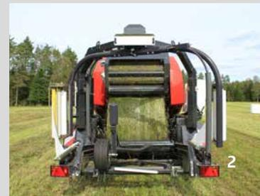
La balle est déposée directement sur la table d'enrubannage.
