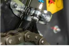
La lubrification automatique des chaînes en standard sur RF4225.
