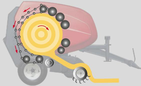
**Chambre de pressage RotaMax** : section avant à rouleaux avec porte arrière à chaînes et barrettes pour une excellente rotation des balles, même dans les conditions les plus sèches.
