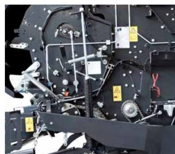
Circuits hydrauliques avec tubes rigides.
