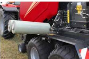
Réserve de film étirable à commande hydraulique pour un confort d'utilisation maximal.
