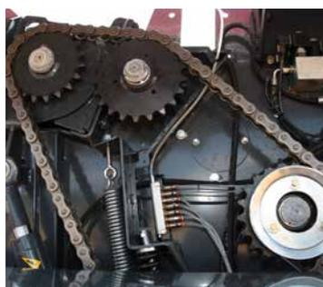
Les entraînements de la chambre principale sont assurés par une chaîne 1" ¼ pour une durée de vie plus longue et une maintenance réduite.
