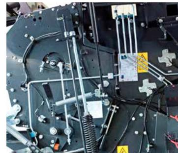
Circuits hydrauliques en tubes rigides en acier.
