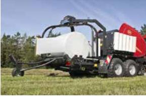
Enrubanneuse double satellite munie de 2 pré-étireurs et de 4 courroies sans fin pour un enrubannage rapide et régulier.
