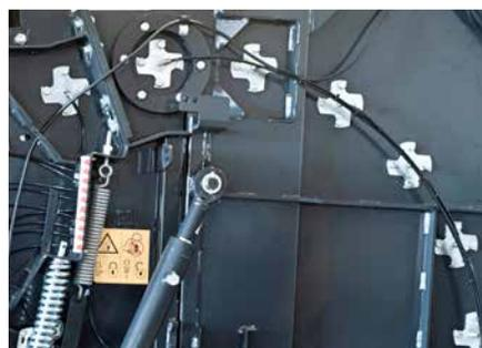
Tous les rouleaux sont montés sur des roulements graissables et résistants. L'entretien des roulements s'effectue facilement à partir de banques de graissage centralisées.
