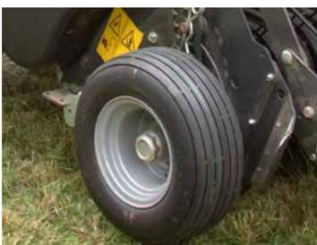
Roues de jauge avec réglage de la hauteur de ramassage.
