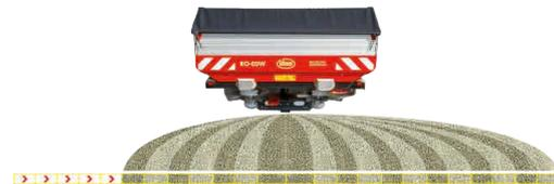
Diminution de la largeur d'épandage de la gauche vers la droite, de 10 mètres
