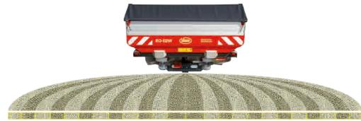
Largeur de travail maximale de 54 mètres avec 24 sections
