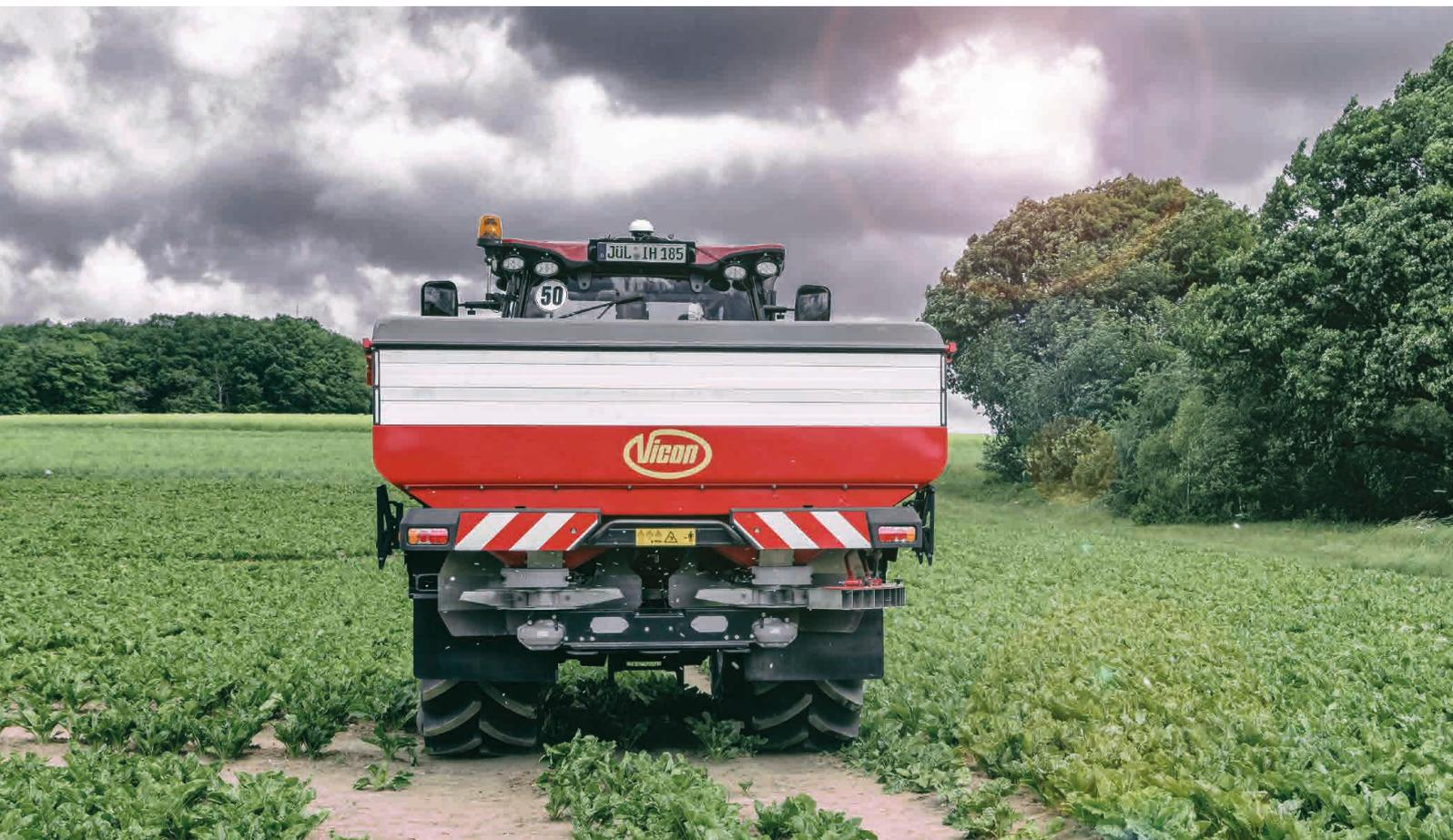
*Un déflecteur de bordure est un accessoire qui est utilisé pour épandre la juste quantité d'engrais jusqu'à, ou depuis, la bordure du champ. Avec d'un côté une projection d'engrais qui doit aller jusqu'en bordure de parcelle pour un maximum de rendement, mais d'un autre côté ne pas dépasser le bord du champ pour avoir un impact écologique mineur et éviter les pertes d'intrants.*
