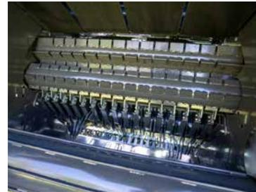
Les rouleaux agressifs assurent une formation instantanée des balles et sont équipés de racleurs autonettoyants conçus pour travailler dans des conditions de fourrage humide.
