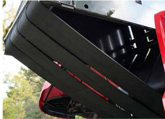
Les VariBale 160 et 190 sont équipées de quatre courroies sans fin haute résistance, qui permettent une bonne mobilité de la balle et qui nécessitent peu d'entretien.
