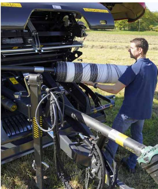
La très faible hauteur et la facilité de chargement du filet permettent de minimiser les temps d'arrêt et de maximiser le temps de pressage.
