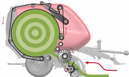
2. Une balle de haute densité avec un petit noyau est produite. Les balles de paille sont moins vulnérables aux mauvaises conditions météorologiques et les balles d'enrubannage conservent mieux leur forme, ce qui facilite le stockage et la manutention.
