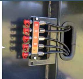
Chaque roulement est clairement identifié à partir de la banque de graissage afin de simplifier l'entretien.
