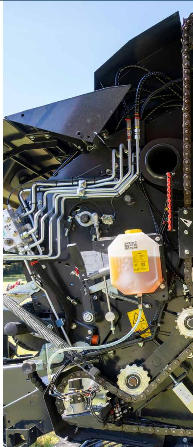
Les pignons de grand diamètre et l'absence d'angle important des chaînes contribuent à une transmission efficace de la puissance et à une longue durée de vie des composants.
