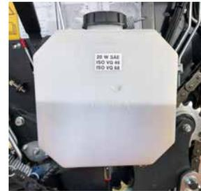
Réservoir de lubrification de grande capacité.
