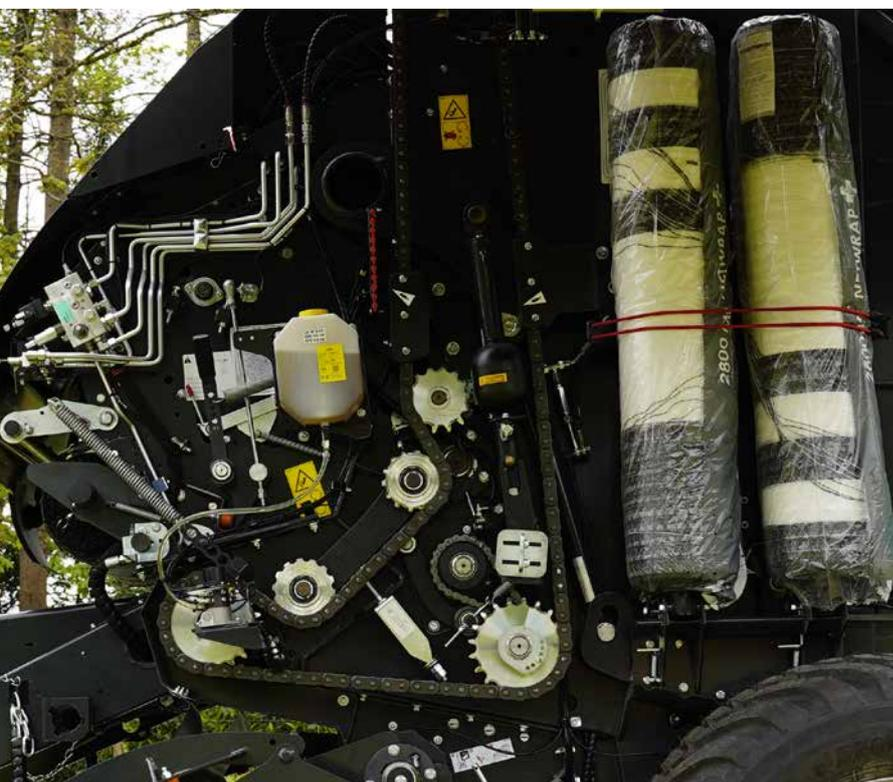
Le stockage vertical des rouleaux de filet permet un meilleur accès à la transmission de la presse.
