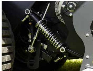
Relevage hydraulique du pick-up avec système de suspension intégré pour un suivi précis du sol.
