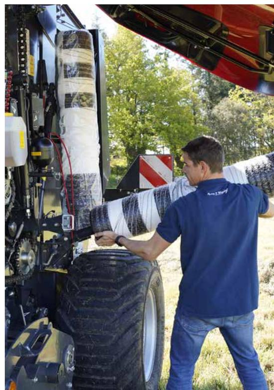
Le stockage ingénieux des rouleaux de filet permet un chargement horizontal confortable.
