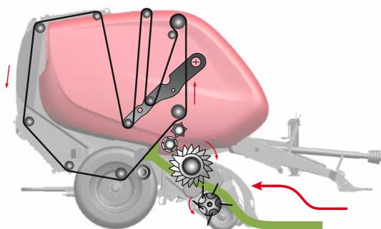
1. La combinaison des rouleaux agressifs et des courroies sans fin haute résistance permettent un démarrage instantané et une bonne rotation de la balle quels que soient les conditions et le type de fourrage pour obtenir des balles denses et bien formées.
