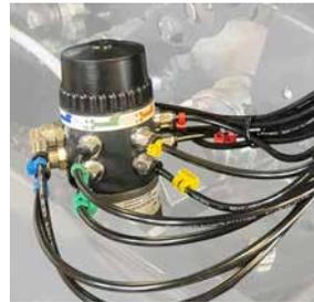
Lubrification automatique avec réglage possible du débit sortie par sortie.
