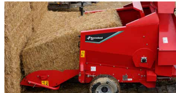
A bálázott anyag egyszerű önrakodása.
