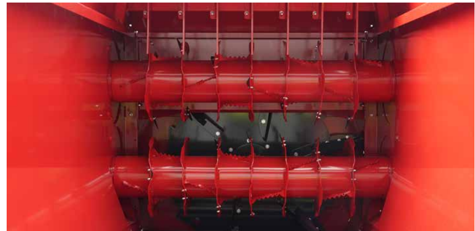
Kétdobos megoldás, amelyet nagy mennyiségű anyag kezelésére terveztek.
