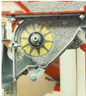
Beállítás apró maghoz, forgó tisztító kefével
