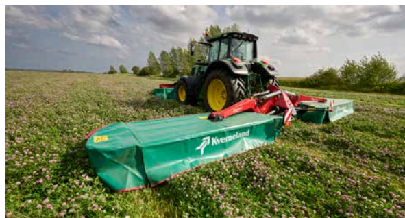
Középen felfüggesztett kialakítás a kiváló talajkövetés érdekében.
