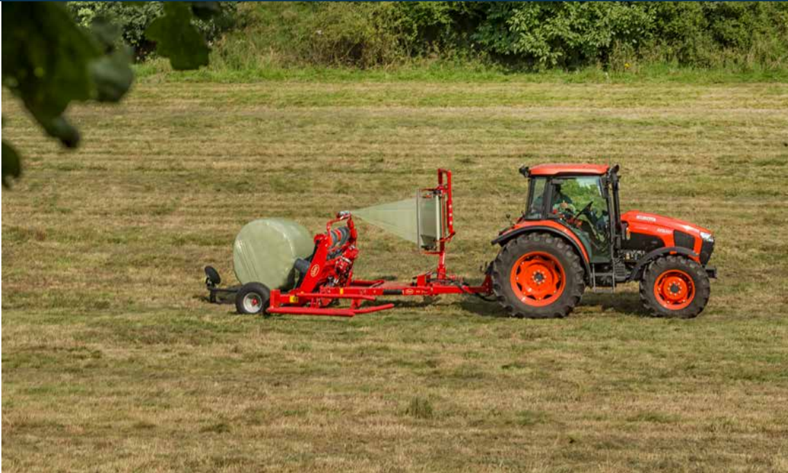
A rakodókar teljesen leengedésre kerül a talajra, hogy kiemelje a kereket, így az könnyen átfordítható a munkahelyzetből a szállítási pozícióba.
