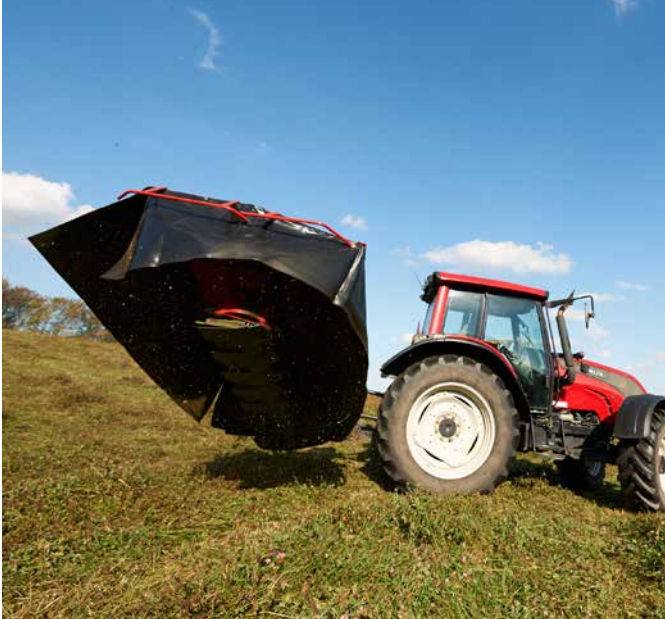
Emelés táblavégi fordulón hidraulikus hengerrel.
