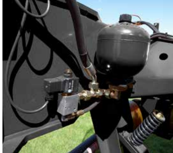
A hidraulikus felfüggesztés biztosítja a talajnyomás pontos beállítását (EXTRA 440H).
