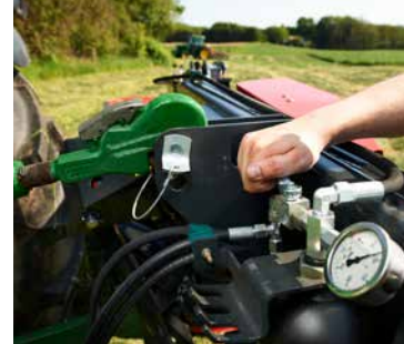
A talajnyomás hidraulikus beállítása (EXTRA 432H és 436H).
