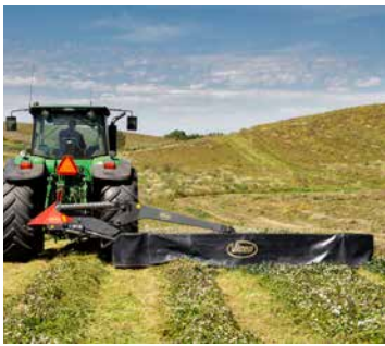
A lekaszált terményen való áthajtás elkerülésére egy rendterelő lemez opcionálisan elérhető a EXTRA 436H és 440H gépekhez.
