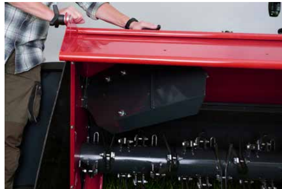
A rendterelő lemezek közvetlenül kinyílnak, amikor befelé csúsztatjuk az állító csavarokat, ezáltal segítve a hatékony és pontos rendképzést.
