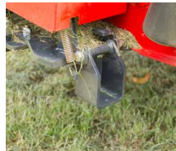
A parkolólab könnyen aktiválható és a fűkaszát vízszintesen tartja a tárolás során.
