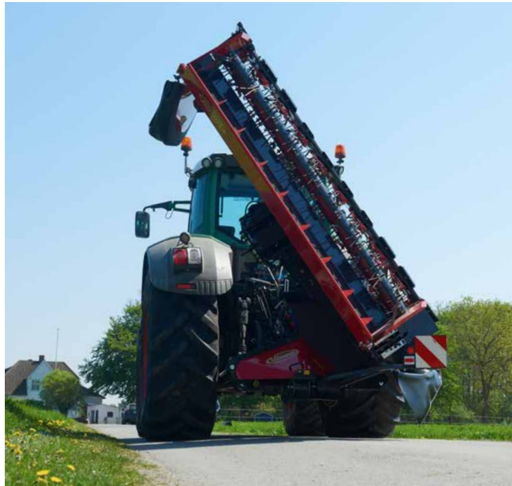
EXTRA 736T Vario szállítási helyzetben. A teleszkópos függesztőkar behúzva a lehető legalacsonyabb helyzetbe áll, így a szállítási magasság mindössze 3,70 méter.
