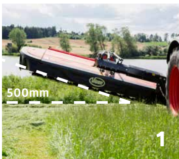
A minimum 500 mm hasmagasság a teljes gép alatt a táblavégi fordulón. A kaszaegység kiemelésre kerül és a függesztő kar 10° szögben felfelé mozdul.
