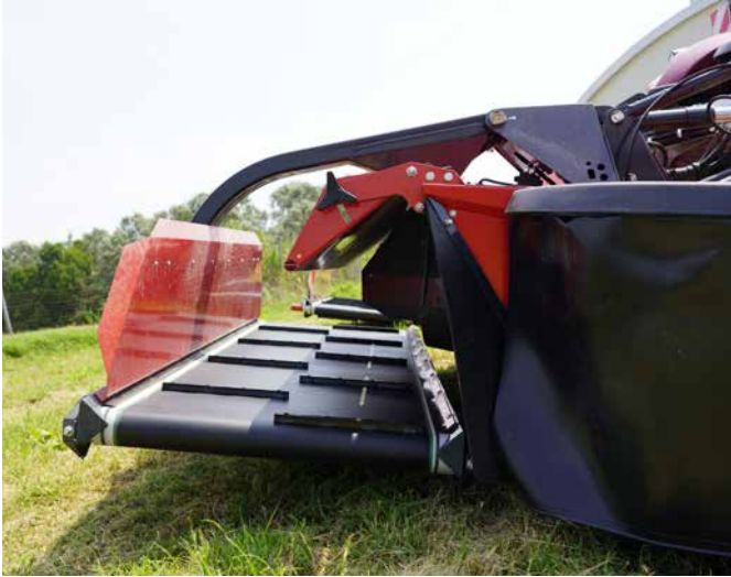
A széles rendrakószalagok lehetővé teszik nagy mennyiségű termény hatékony kezelését.
