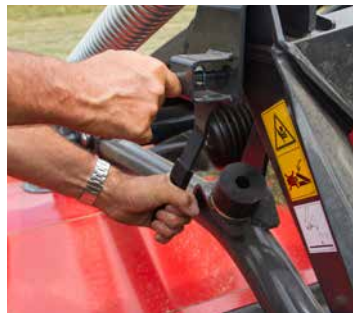
Egy kezes rögzítő kar tároláshoz - a gép lezárásához és a leszerelés előkészítéséhez.
