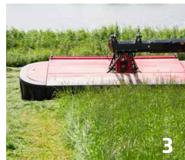
A kaszaegység leeresztésekor egyenletesen süllyed a talajra anélkül, hogy valamelyik oldal a kasza többi része előtt érne a talajhoz.
