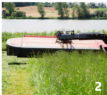
A függesztő kar visszaáll az eredeti vízszintes helyzetébe, még mielőtt a kasza leengedésre kerül.
