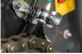
A lánc automatikus kenése az alapkivitel része az RF4225 Plus modellnél.
