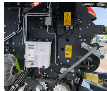
Merev acélcsövek a hidraulika körökben.
