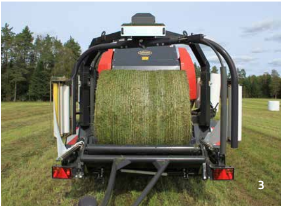
Amint a bála továbbítódik a bálázótól, a bálakigurító azonnal becsukódik és a következő bála készítése elkezdődik.
