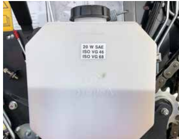
Nagy kapacitású lánckenőolaj-tartály.
