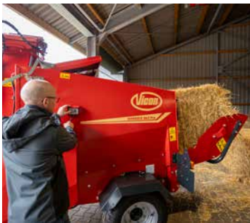
A kamraajtó és a láncos behordószerkezet működtetése biztonságos távolságra a mozgó alkatrészekről, a kamra oldalán elhelyezett távirányító használatával.
