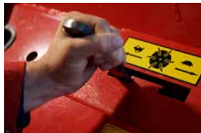
Könnyű átváltás almozásról etetésre a 2-fokozatú hajtóművel.
