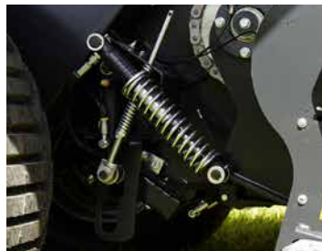
Hidraulikus rendfelszedő beépített csillapítással, a talajhoz való pontos alkalmazkodás érdekében.
