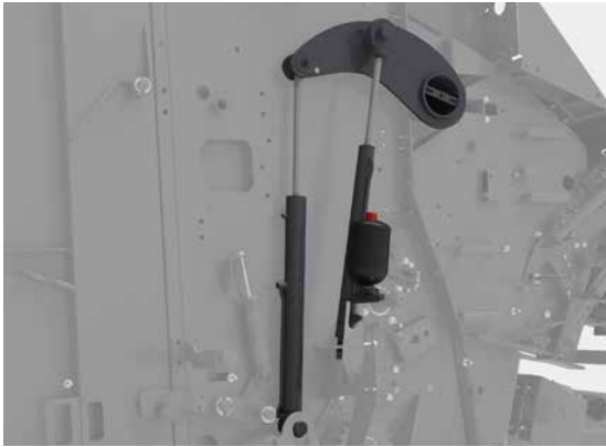
A hidraulikus hevederfeszítő lehetővé teszi a hátsó ajtó gyors bezárását, ami nagy termelékenységet biztosít.
