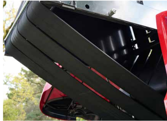
A VariBale modellek négy darab tartós, végtelenített hevederrel vannak felszerelve, amelyek egyenes futást és alacsony karbantartási igényt biztosítanak.
