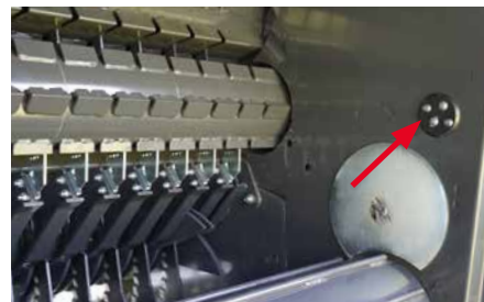
A nedvességérzékelő szenzor elhelyezése a kamra belsejében.
