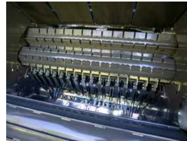
A profilos hengerek azonnali bálaképzést biztosítanak és öntisztító kaparókkal vannak felszerelve a különféle körülmények közötti munkavégzéshez.
