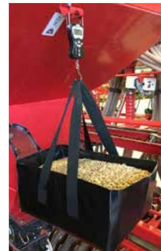
Un kit di calibrazione è fornito standard, i test di calibrazione possono essere effettuati elettricamente o manualmente.
