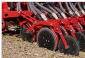
La seminatrice e-drill ad elemento di semina CX-II a doppia entrata combinata con il serbatoio frontale DF1 (max. 1.700 L) o l'e-drill maxi plus con tramoggia sdoppiata, possono posizionare contemporaneamente due prodotti nella stessa fila con un solo passaggio.
