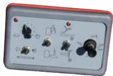
Il terminale di controllo permette di vedere lo stato del DFCS.
