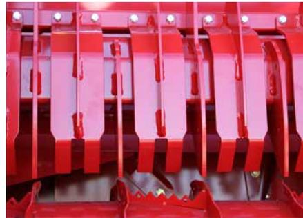
Il DFCS è inserito riducendo il rischio di intasamento durante il carico e l'avvio della turbina.
