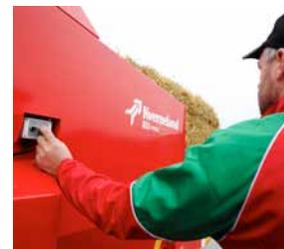
È anche possibile gestire da terra e in sicurezza entrambe il portellone e il convogliatore tramite il comando sul lato della macchina.
