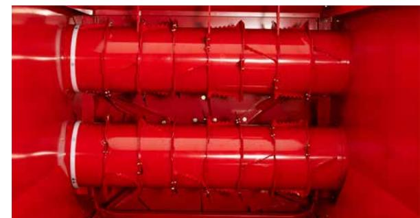
I due tamburi del modello 856 Pro hanno coltelli con angolazione che permette il passaggio alternato a destra e sinistra delle creste del pettine. Distribuzione regolare, ridotti bloccaggi e pulizia di lavoro.
