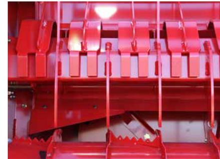
Il DFCS è disinserito per permettere il massimo flusso di prodotto alla turbina.
