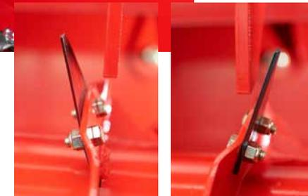
Per un taglio omogeneo, i coltelli del tamburo sfiorano le creste fisse alternativamente a destra e a sinistra - sistema brevettato Kverneland.
