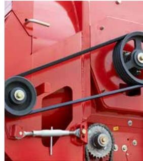
Azionamento tramite cinghia a V - bassa manutenzione e silenziosità del tamburo.
