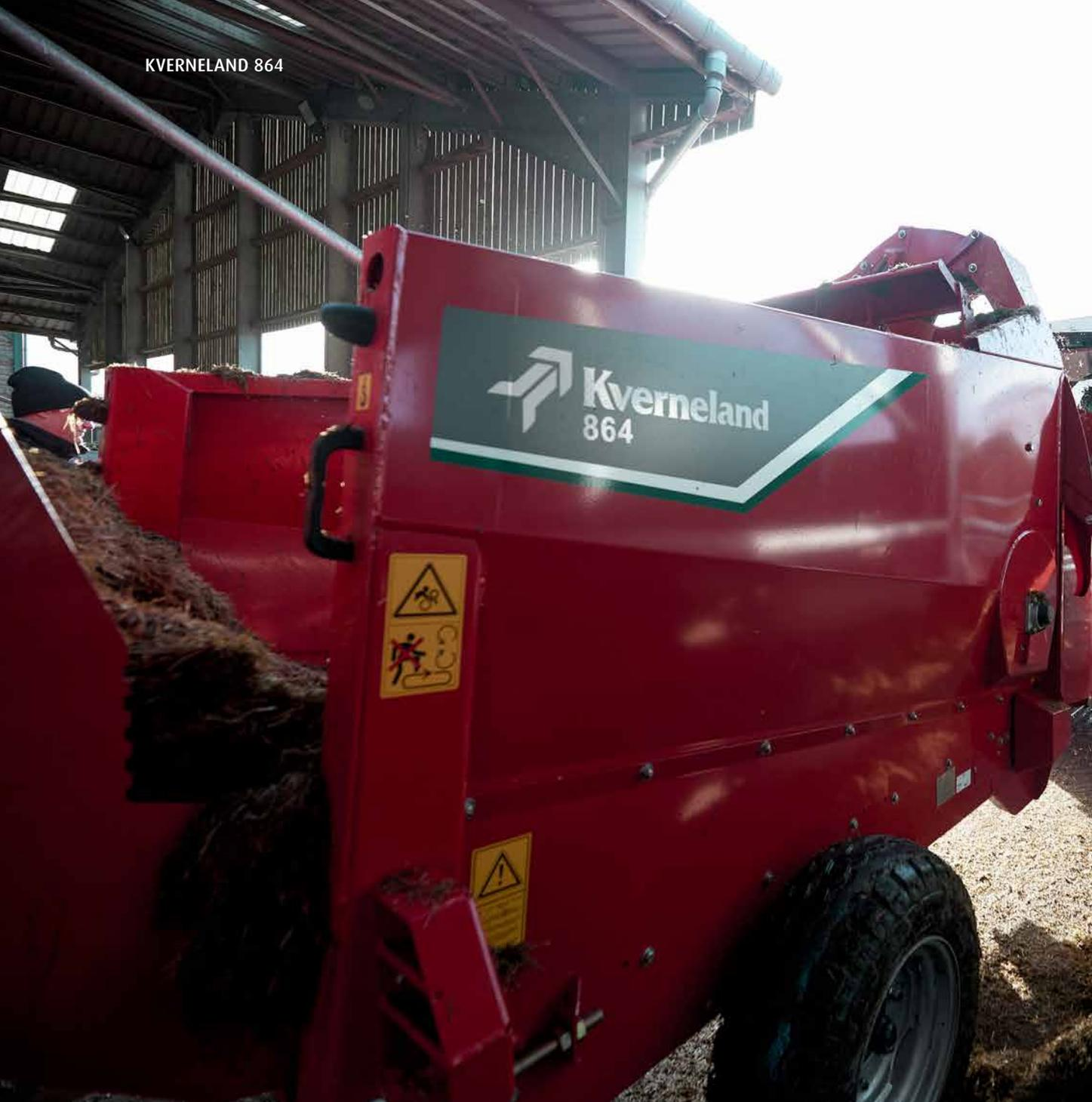
In aggiunta al terminale di controllo in cabina, il modello 864 è dotato di un comando esterno del convogliatore e del portellone. La possibilità di azionare tali funzionalità dal lato della macchina salva tempo prezioso durante il carico.
