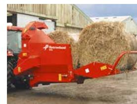
Il design del portellone posteriore e il dispositivo di ritenzione (a richiesta) offrono la possibilità di carico di un'extra balla.
