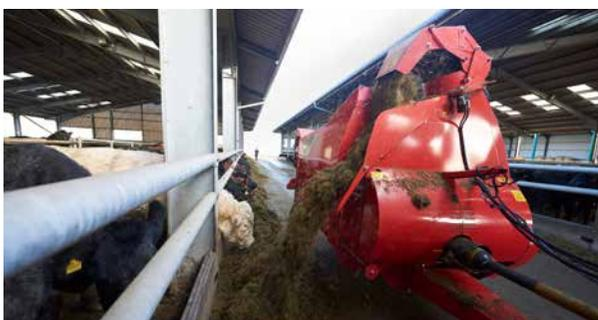
Lo scarico azionato idraulicamente in 3 posizioni ottimizza la distanza di lancio quando si distribuisce il materiale di lettiera.
