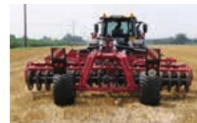
Semplice conversione da lavoro a trasporto. Le due parti a chiusura idraulica permettono una larghezza di trasporto di 2.55m nel modello portato e 2.75m nel modello trainato. Le sospensioni idrauliche assicurano il buon funzionamento e trasporto sicuro su strada.
