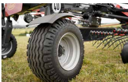
Ruote di trasporto da 380 mm e parafanghi per la macchina pulita durante il trasporto.
