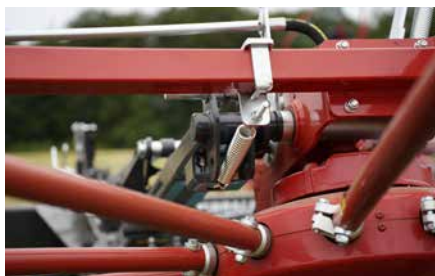
Molla sulla testata del rotore per maggiore stabilità su terreno collinare o irregolare.
