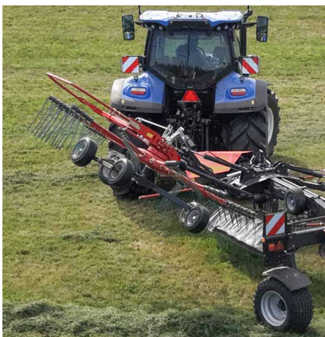
Per uso frequente o integrazione nel Section Control del trattore, ciascun rotore può essere sollevato tramite una valvola a semplice effetto dedicata.
