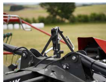
Le sicurezze idrauliche opzionali consentono l'apertura senza uscire dal trattore o tirare una corda.
