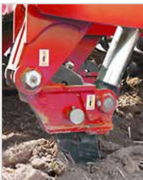
De Pro-Lift tand met hydraulische auto-reset.
