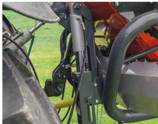
Kantstrooien met schuinstelcilinder - strooien richting de grens vanaf het eerste rijspoor
