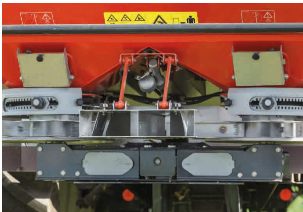
Enkelzijdig kantstrooien - Strooien vanaf de kant met de kantstrooiplaat.
