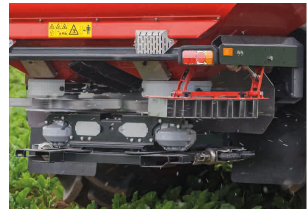
Kantstrooien - strooien tot de grens met de ExactLine
