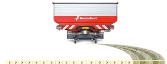
Secties vanaf één zijde overschakelen over het midden.
