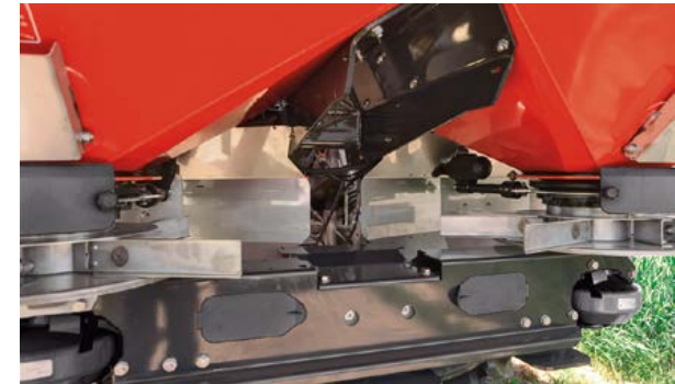
Één elektrische aandrijving om de snelheid van de toediening te regelen.
