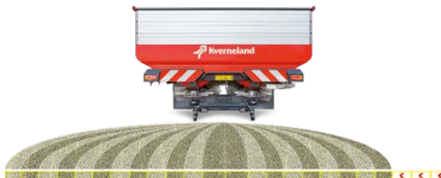
De strooibreedte aan de rechterkant met 6 m verminderen
