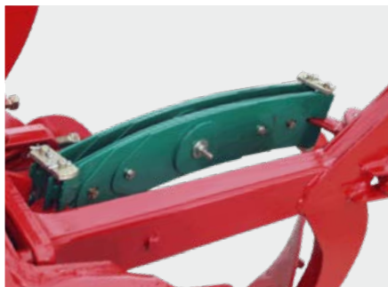
Dubbele veren pakket met 14 bladveren (1400 kp)
