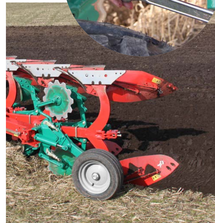
Eenvoudige en snelle instelling van de werkdiepte met Y-schroeven
