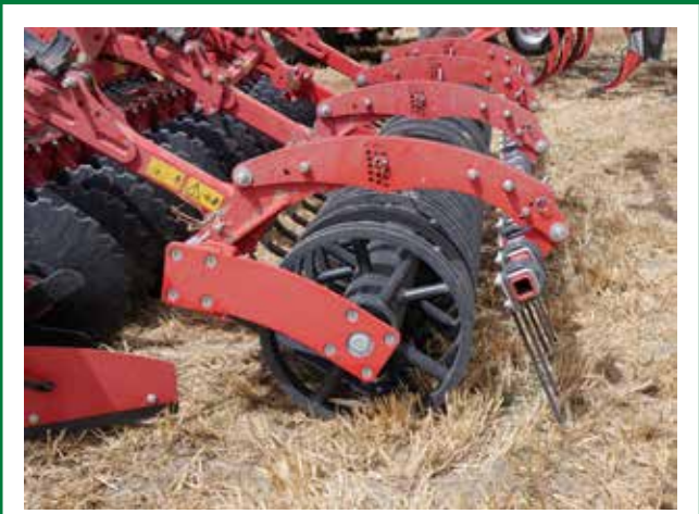
De enkele vinger-volgende eg ( \varnothing 12 \times 450\text{mm} ) is beschikbaar voor alle rollen. Interessant voor ondiepe teelten en mechanisch wieden. De eg zorgt ook voor een gelijkmatige nivellering.
