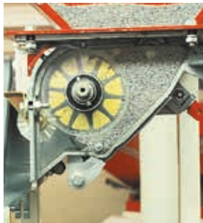
Instelling voor fijne zaden, met roterende borstel
