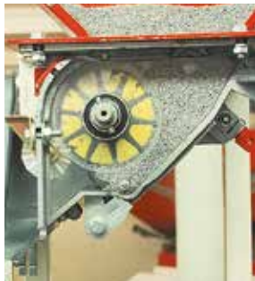
Instelling voor fijne zaden, met roterende borstel
