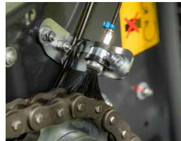
Automatische kettingsmering is standaard op de FixBale 500
