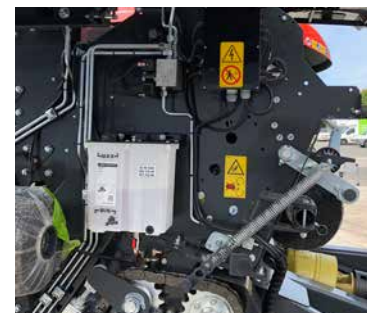
Stalen buizen voor de hydraulische circuits.
