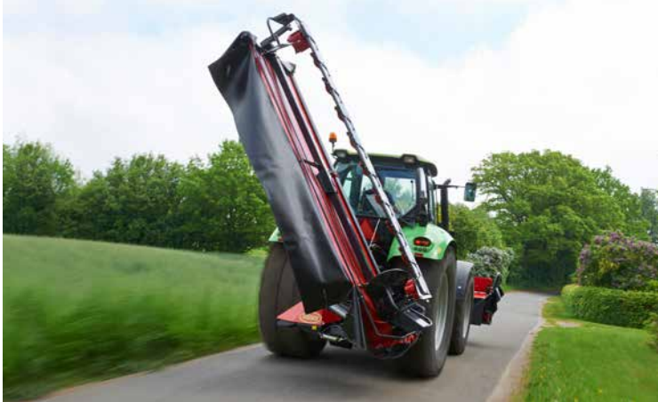
125° verticale transportpositie voor een uitstekende gewichtsverdeling.
