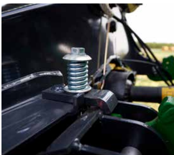
Als een obstakel geraakt wordt, kan de maaibalk omhoog en tegelijkertijd naar achteren zwenken.
