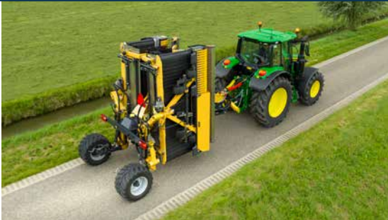
De Vicon ROC RS 730 kan worden ingeklapt tot een breedte van slechts 2,5 meter voor wegtransport.
