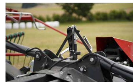
Opcjonalne hydrauliczne blokady transportowe umożliwiają rozłożenie maszyny bez opuszczania kabiny lub ciągnięcia liny.
