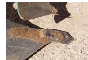
Kształt dłuta Knock-on® zabezpiecza inne elementy przed zużyciem
