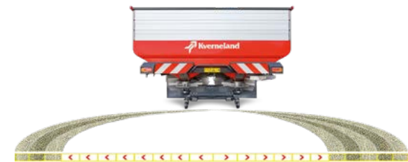
Wyłączenie sekcji od środka na zewnątrz
