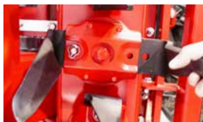
Zęby Quick-Fit można łatwo wymienić bez użycia narzędzi.
