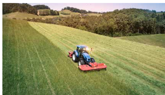
EXTRA 332XF Compact z punktem ciężkości blisko ciągnika jest ważną cechą podczas pracy w pagórkowatych warunkach z mniejszymi ciągnikami.
