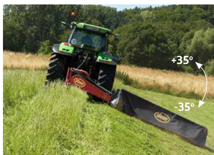
Konstrukcja umożliwia koszenie pod ekstremalnymi kątami.
