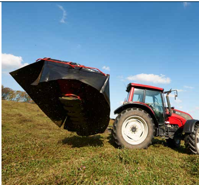
Podnoszenie na uwrociach za pomocą siłownika hydraulicznego.
