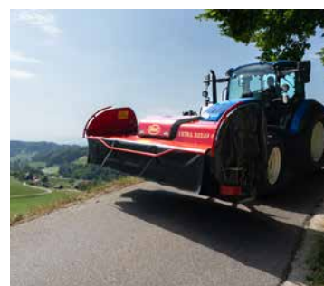
Wąska podczas transportu z dobrą widocznością. Hydraulicznie składane osłony są dostępne jako opcja.
