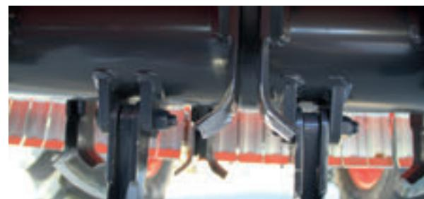
Ротор FXE может быть оснащен универсальными или молотковыми ножами. В стандартной комплектации также идут боковые лыжи.
