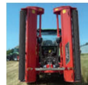
Центральный редуктор (250 л.с.) оснащен колесами свободного хода; боковая трансмиссия с автонатяжителями ремней обеспечивает надежность и низкие эксплуатационные расходы.
