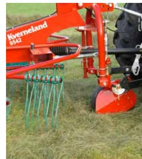
Дополнительное промежуточное колесо позволяет использовать стандартную верхнюю тягу.
