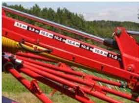
Гидравлическая регулировка ширины захвата в диапазоне от 9,60 м до 11,00 м.
