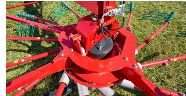
Высоту каждого ротора можно установить независимо с помощью гидравлического устройства.
