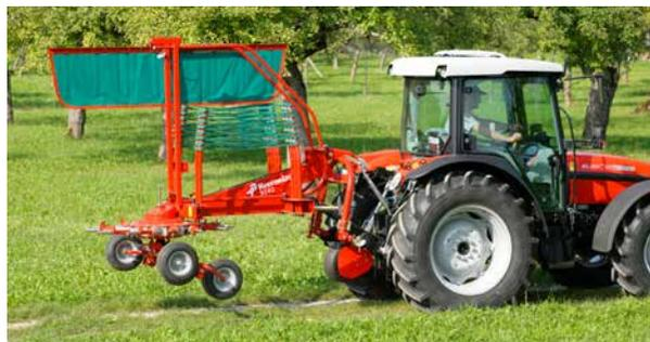
Для транспортировки или хранения защитные рамы ротора складываются в главную раму, положение фиксируется автоматически. Вспомогательная пружина, соединенная с отводной доской, уменьшает требуемую нагрузку.
