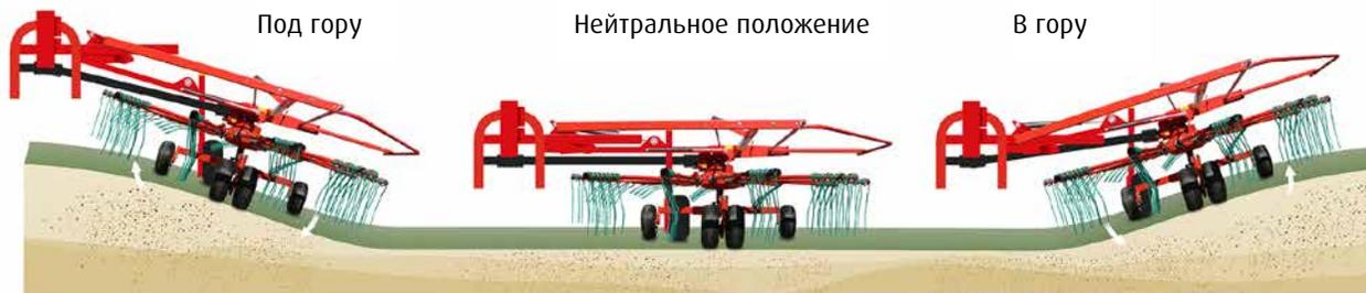
Роторы могут поворачиваться в любом направлении, благодаря чему зубцы идеально следуют контуру грунта....
