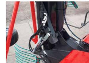
Гидравлическая блокировка при транспортировке (опция).
