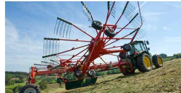
Два ротора гидравлически поднимаются при движении на поворотных полосах.
