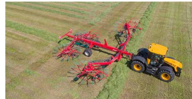
Поскольку уже обработанные участки определены, каждый отдельный ротор поднимается при повороте на разворотной полосе. С каждой новой машиной предоставляется пробная лицензия на 24 часа.
