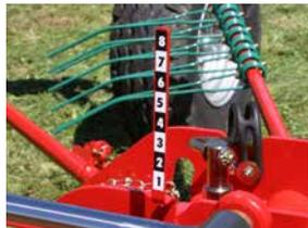
Гидравлическая регулировка высоты роторов в соответствии с длиной стерни или изменяющимися условиями грунта.
