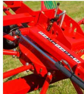
9476 C – Гидравлически регулируемая ширина захвата: 7,0-7,8 м.
