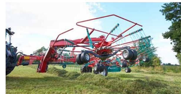
Высокий подъем роторов обеспечивает высокий дорожный просвет при развороте.
