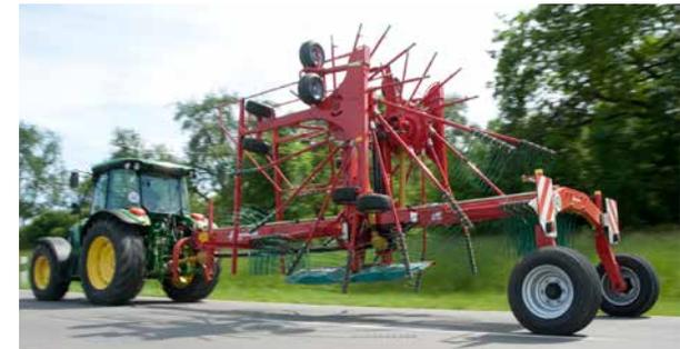
Для достижения высоты при транспортировке ниже 4,00 м грабли снимаются и надежно крепятся.
