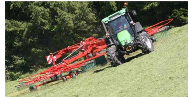
Активное рулевое управление, позволяющее выполнять резкие повороты на поворотных полосах.
