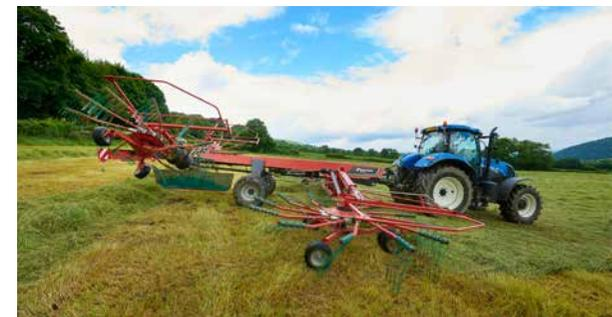
Независимый попарный подъем передних и задних роторов. Функция регулируемой задержки для положения при движении на разворотной полосе входит в стандартную комплектацию.
