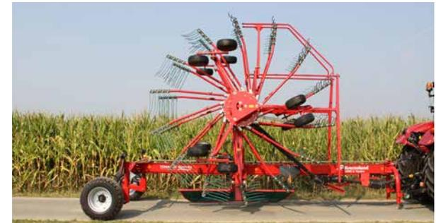
Обладая шириной захвата 9,00 м и высотой при транспортировке меньше 4,00 м, даже без отсоединения граблей...
