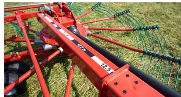
Гидравлическая регулировка ширины захвата и валка.
