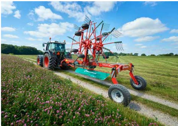
Для транспортировки грабли с централью укладкой складываются гидравлически из кабины трактора.
