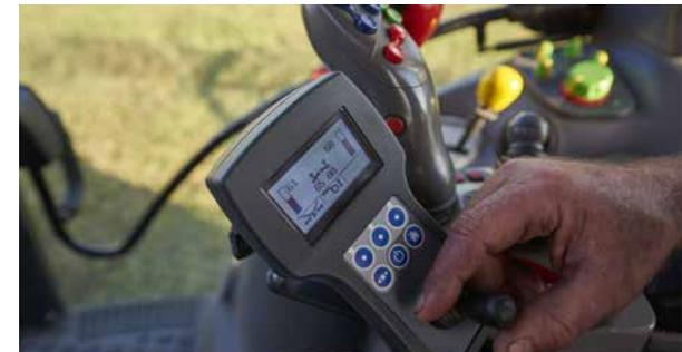
ComfortKit, включает электронное управление высотой отдельных роторов.
