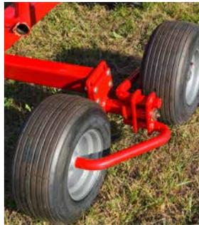
Дополнительные опорные колеса для тележки Quattro для улучшения следования контуру грунта.
