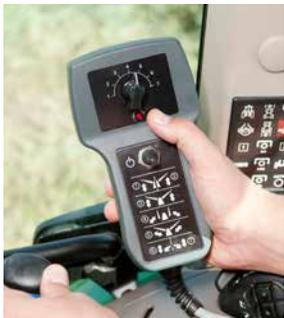
Пульт управления, расположенный в кабине трактора, управляет основными функциями, необходимыми во время работы. Подъем и регулировку высоты роторов можно выполнять независимо. Также, можно легко регулировать ширину захвата, еще на пульте управления также, расположено устройство блокировки при транспортировке.
