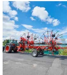
Высота при транспортировке ниже 4,0 м, даже с установленными габринами.
