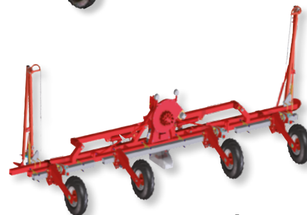
Гидравлически складываемая рама - 6м
