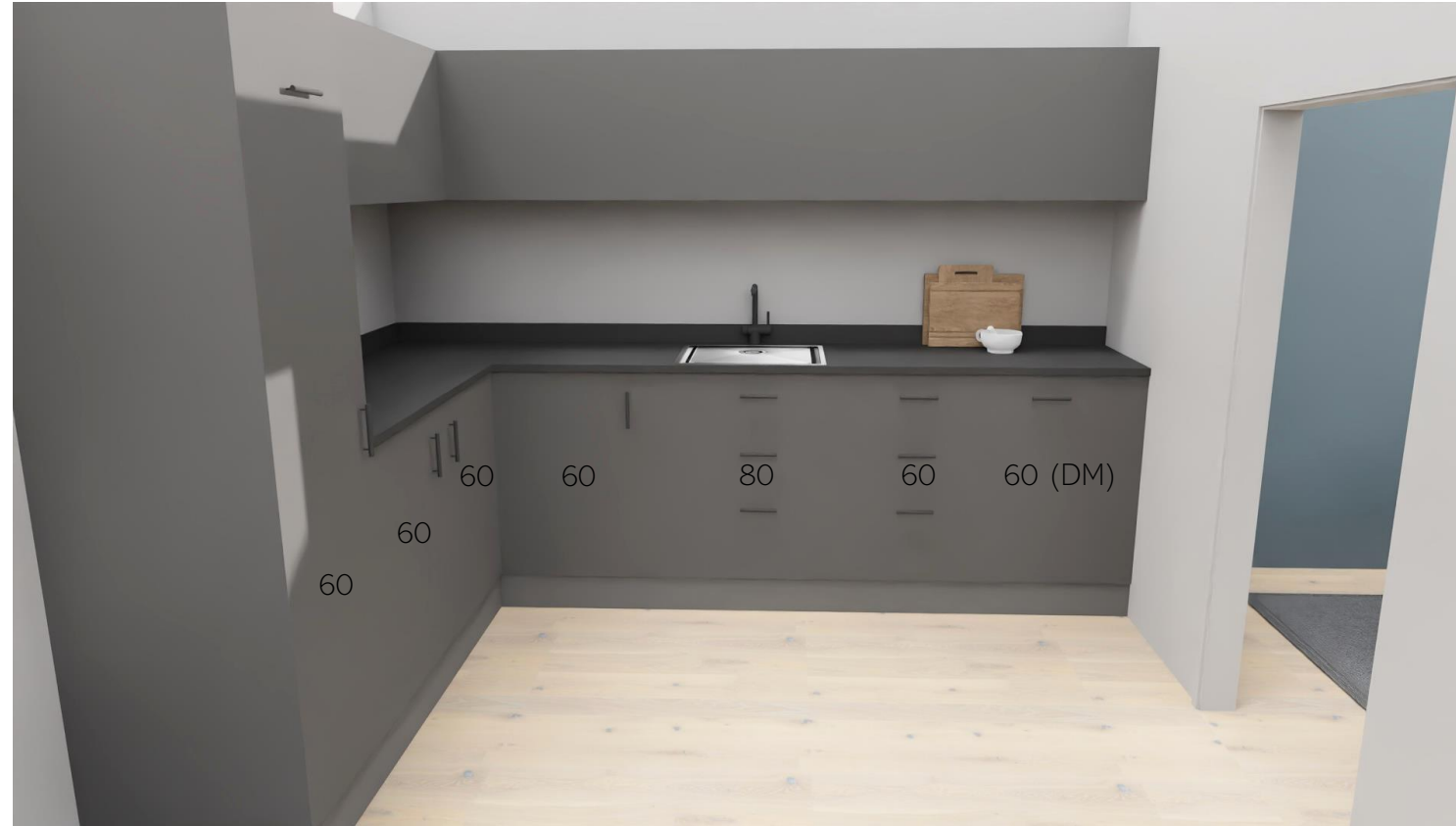
Pentry föreslås i grå kulör med mörk bänkskiva och svarta beslag. Integrerad kyl/frys. Överskåp med push.
