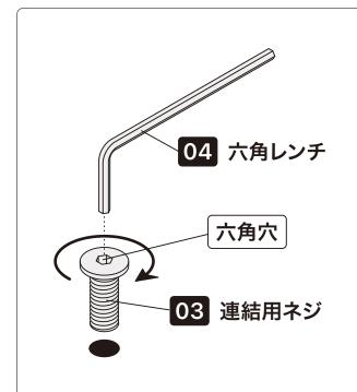
六角レンチは六角穴の奥までしっかりと差し込んでから回してください。完全に差し込まず回すと、六角穴を破損させる可能性があります。
