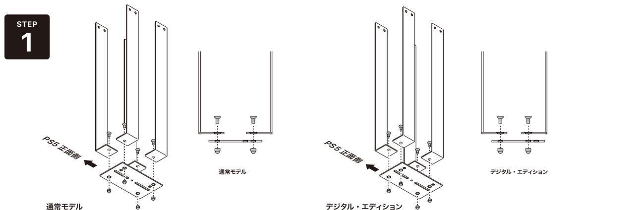
皿ネジと袋ナットを使い、Flat Plate PS5 と Arm Plate PS5 を組み立てます。通常モデルは Flat Plate PS5 の2つ並んだ外側の穴に、デジタル・エディションは内側の穴に Arm Plate PS5 を固定します。
