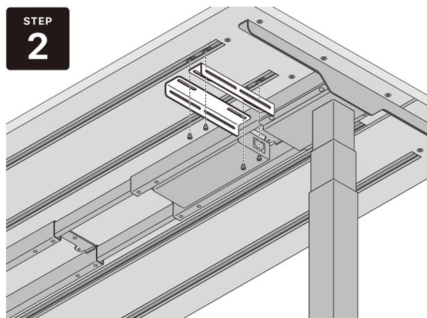
Base Slider (もしくは M6 ボタンネジ) を使用し、レールやネジ穴に Bracket S を仮止めします。
