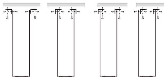
お使いの天板のレールや鬼目ナットの位置に合わせて、Bracket S と Arm Plate PS5 の取り付け位置や向きを変更してください。また、PS5 のディスク挿入口や電源、HDMI ケーブルが昇降脚に干渉しないようご注意ください。
