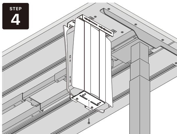
傷をつけないよう慎重に PS5 を設置します。PS5 が入らない場合はレール側の Bracket S のネジを少し緩め、位置を調整し PC5 を設置してからネジを締め直します。Flat Plate PS5 の底面中央にある穴にローレットビスを差し込み、PS5 本体を固定して完成です。
