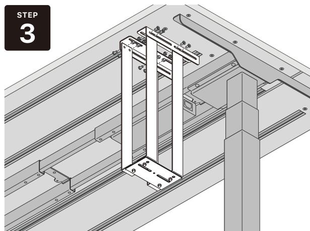
PS5 の横幅やネジ位置に合わせ、低頭ネジと袋ナットを使用し Arm Plate PS5 4つを Bracket S に取り付けます。位置が決まったら仮止めしていた Bracket S をしっかりと固定します。
