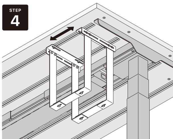
仮止めしている Bracket と Arm Plate を 筐体の横幅に合わせて位置調整します。
