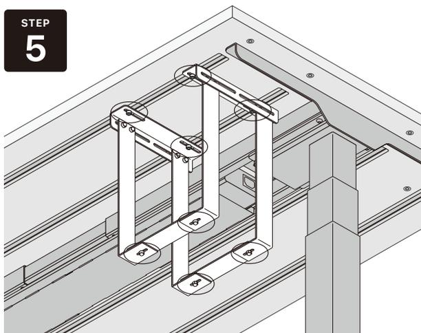
仮止めしていた Bracket と Arm Plate のネジをしっかり固定して完成です。
