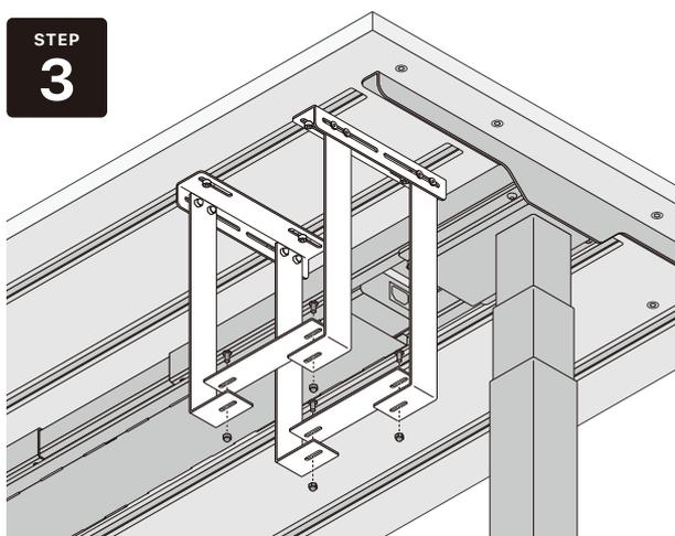
ネジとナットを使用し、Arm Plate 同士と Flat Plate を L Wide は 8 カ所、その他は 4 カ所仮止めします。
