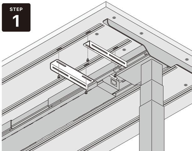
Base Slider（もしくは M6 ボタンネジ）を使用し、レールに Bracket を仮止めします。
