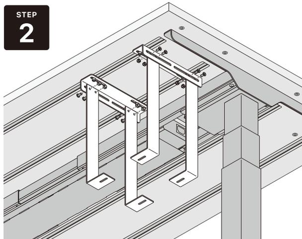
筐体の奥行きに合わせ、ネジとナットを使用し Arm Plate 4つを Bracket にしっかりと固定します。
