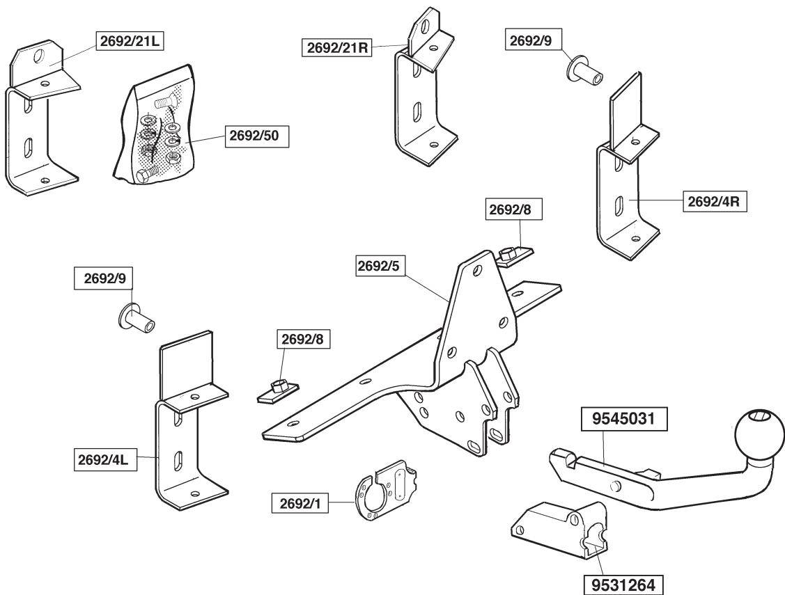
1. Verwijder de vloerplaat van de kofferbodem. Maak het linker en rechter zijpaneel los. Verwijder de bumper hiertoe dient men de kunststof afdekplaat aan de bovenzijde van de bumper te verwijderen. Verwijder de vulstukken in de hoeken onder de achterlichten. Verwijder het sleepoog. Het verwijderde sleepoog wordt niet herplaatst. Dicht het sleepoogbevestigingsgat af. Zaag in het midden aan de onderzijde een deel van 80x35mm uit de bumper.
