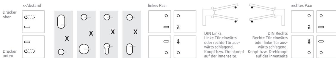
X-Abstand ist der Abstand zwischen Drücker - und Schlüsseldrehachse (Lochabstand). Die Messweisen bei verschiedenen Schlössern können Sie aus der obenstehenden Abbildung entnehmen.
