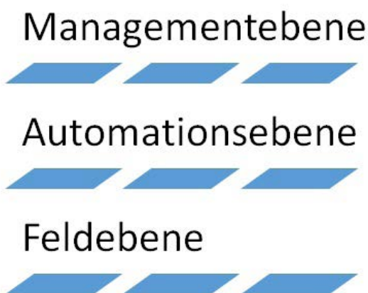
Bild 3. Feld-, Automations- und Managementebene sind die kennzeichnenden Schichten eines Gebäude-Automatisierungssystems.
