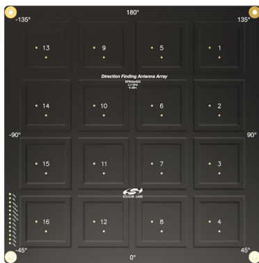
Bild 5. Das Silicon Labs Direction Finding Antenna Array, das in der Bluetooth Direction Finding Lösung von SiLabs verwendet wird. (Bild: Pressebild Silicon Labs)
