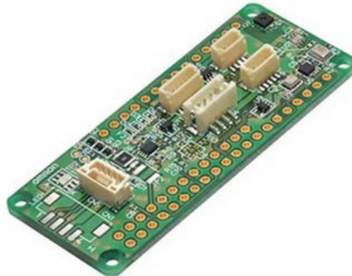
Bild 7. Omron bietet drei verschiedene Varianten des 2JCIE-EV01 Sensor Evaluationboards an, je nachdem, ob der Prototypen auf Raspberry Pi, Arduino oder Adafruit Feather gehostet werden soll. Das Bild zeigt das Omron Adafruit *3 Entwicklungskit . Es unterstützt sechs Arten von Sensorfunktionen. (Bild: RS Components)
