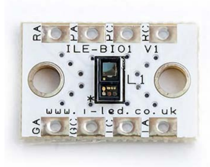
Bild 22. Die Platine BIOFY Eco1 SFH 7050 verfügt über Befestigungsbohrungen für M3-Schrauben und hat Abmessungen von 20,25mm x 13,7mm x 0,9mm. (Bild: RS Components)
