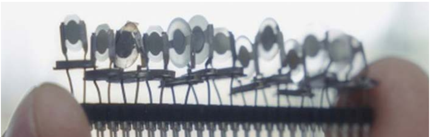
Bild 14. Wie eine Nase sieht es so gar nicht aus: eine Kombination von Sensoren und Materialien ermöglicht hier den künstlichen Geruchssinn. (Bild: Pressefoto Amadeus Bramsiepe, KIT)
